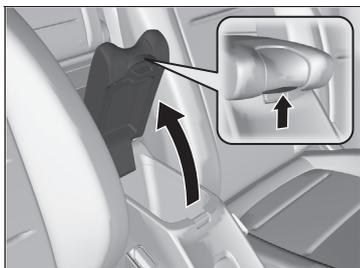
Tire de la palanca para abrir el compartimento de la consola.
