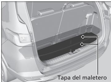
La tapa del suelo del maletero se puede elevar o bajar en función del equipaje.
