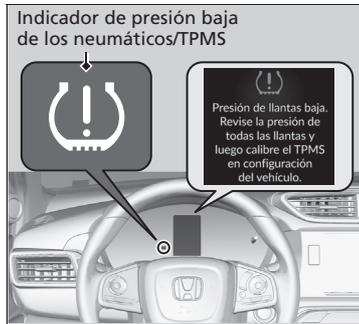
Esto provocará que el testigo de la baja presión de los neumáticos/TPMS se encienda y aparecerá un mensaje en la interfaz de información del conductor.
