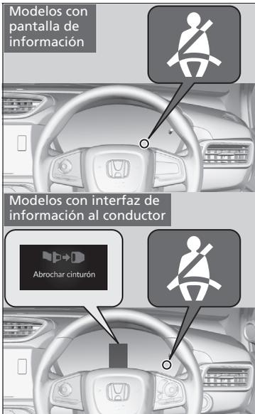
El sistema del cinturón de seguridad incluye un indicador en el panel de instrumentos para recordar al conductor, al acompañante o a ambos que deben abrocharse los cinturones.
