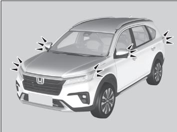
Si el motor se para, las luces exteriores parpadearán una vez.
