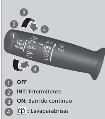
Los limpiaparabrisas y lavaparabrisas se pueden utilizar cuando el interruptor de encendido está en la posición de CONTACTO \*1.
