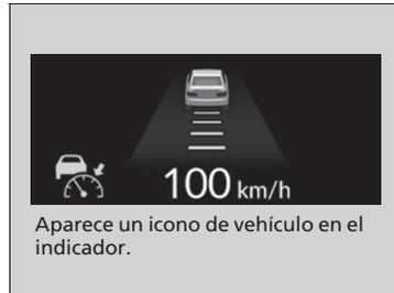
Cuando un vehículo con una velocidad inferior a la que tiene programada en el suyo se acerca por delante o se cruza delante y la cámara lo detecta, su vehículo comienza a reducir la velocidad.
