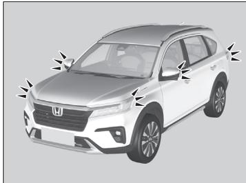
Si el motor se arranca, algunas luces exteriores parpadean seis veces.
