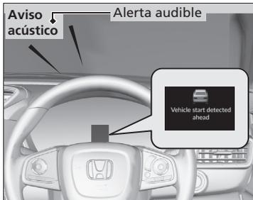
Cuando el sistema se activa, suena el aviso acústico y aparece un mensaje en la interfaz de información del conductor.
