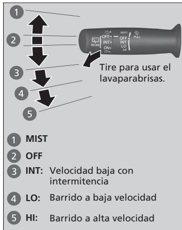
El limpia/lavaparabrisas se puede utilizar cuando el interruptor de encendido está en la posición de CONTACTO **II**\*1.
