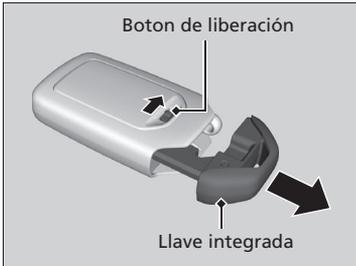
Se puede utilizar la llave integrada para bloquear/desbloquear las puertas y el maletero cuando la pila del control a distancia de acceso sin llave se está agotando y se desactiva el bloqueo/desbloqueo eléctrico de las puertas.
