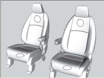
La ventilación de los asientos se puede utilizar cuando el modo de alimentación está en la posición de CONTACTO.
