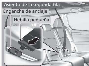
2. Alinee las marcas triangulares de la hebilla pequeña y del enganche de anclaje. Asegúrese de que el cinturón de seguridad no esté retorcido. Fije el cinturón al enganche de anclaje.
