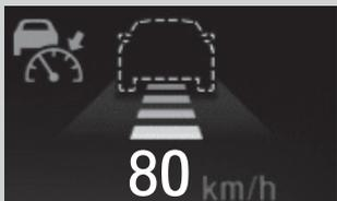
Aparece un icono de vehículo con un contorno de línea de puntos en la interfaz de información al conductor.
