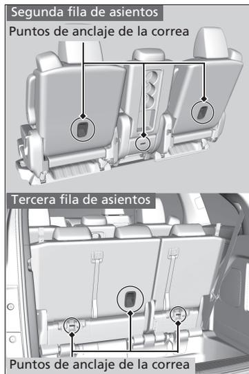
Hay un punto de anclaje para la correa detrás de cada asiento de la segunda y tercera filas. Si dispone de un sistema de sujeción infantil que incluye una correa de sujeción pero que se puede instalar con cinturón de seguridad, puede utilizar la correa para obtener una mayor seguridad.
