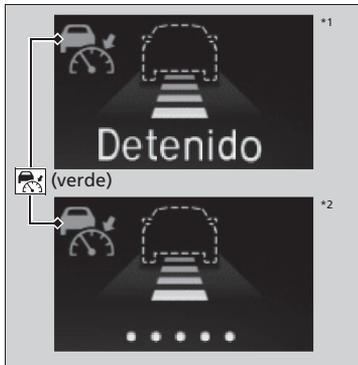
Si no tiene ningún vehículo delante antes de reanudar la conducción, pise el pedal del acelerador y el ACC con seguimiento de baja velocidad reanudará el funcionamiento con la anterior velocidad programada.
