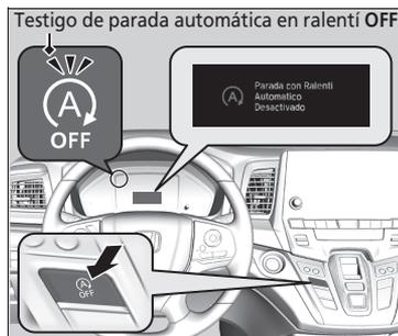
Para desactivar el sistema de parada automática en ralentí, pulse este botón. El sistema de parada automática en ralentí se detiene.
