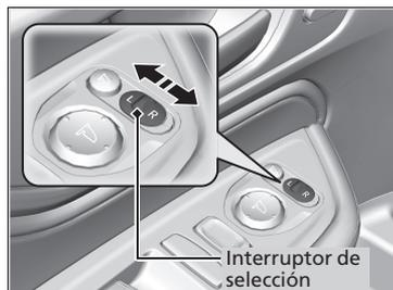
Si está activada esta función, los retrovisores de las puertas se inclinan automáticamente hacia abajo cuando se coloca la palanca de cambios en la posición **R**; esto mejora la visibilidad en el lado de interés al retroceder. El retrovisor regresa automáticamente a su posición original cuando se quita la palanca de cambios de **R**.
