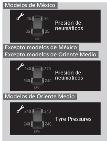
Para seleccionar el monitor de presión de los neumáticos, siga estos pasos con los botones del volante.
