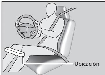
El airbag de rodilla del conductor y el del pasajero están almacenados debajo de la columna de la dirección y de la guantera, respectivamente.
