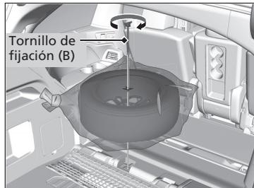
3. Coloque el neumático pinchado boca abajo en el punto de acoplamiento.
