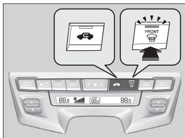
Al pulsar el botón
