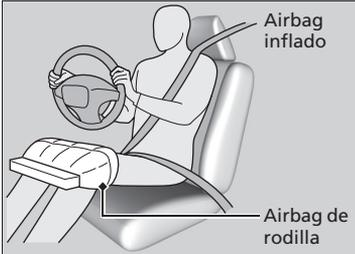
El airbag de rodilla del conductor y el acompañante se despliegan a la vez que los airbags delanteros.
