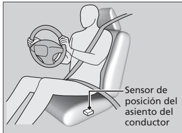
El sistema de airbag avanzado del conductor incluye un sensor de posición del asiento.
