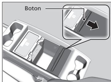
Para abrir el compartimento de la consola, presione el boton para desbloquear la tapa y luego deslícela hacia atrás.
