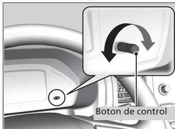
Cuando el modo de alimentación está en CONTACTO, puede usar el boton de control de brillo para ajustar el brillo del tablero de instrumentos.
