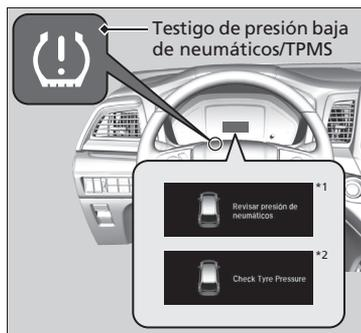
Controle la presión de los neumáticos mientras conduce. Si la presión de los neumáticos del vehículo se reduce significativamente, el indicador de presión baja de neumáticos/TPMS se enciende y aparece un mensaje en la interfaz de información al conductor.
