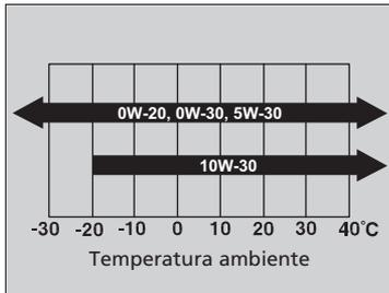
Utilice aceite de motor original Honda u otro aceite de motor comercial del grado de viscosidad adecuado para la temperatura ambiente según se indica.
