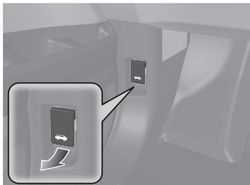
**2** Localice la palanca del cerrojo del cofre, tire de ella y levante el cofre. Una vez levantado el cofre ligeramente, puede tirar de la palanca.
