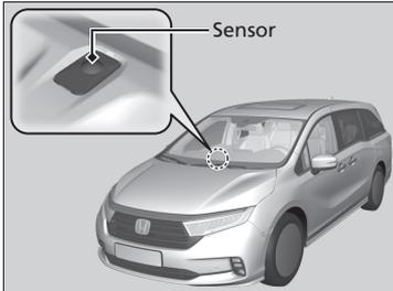
El sistema de aire acondicionado automática está equipado con sensores. No los tape ni vierta líquidos sobre ellos.
