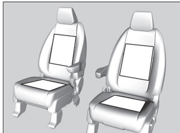
La ventilación o la calefacción de los asientos se pueden utilizar cuando el modo de alimentación está en la posición de CONTACTO. La calefacción de los asientos: úsela para calentar el asiento. La ventilación de los asientos: úsela cuando desee ventilar la superficie de los asientos. Si se usa con el aire acondicionado, la superficie de los asientos se enfriará más fácilmente.
