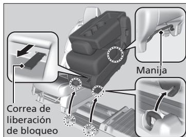
1. Primero, guarde el cinturón de seguridad central. Introduzca la hebilla en la ranura lateral del enganche de anclaje.
