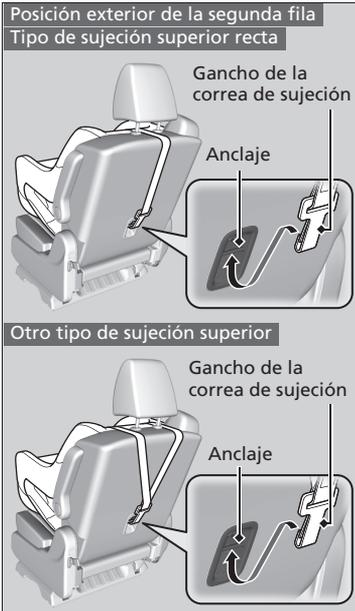
3. Coloque la cabecera en su posición más alta, dirija la correa de sujeción fuera de/entre las patas de la cabecera y sujete el gancho de la correa de sujeción en el anclaje.
