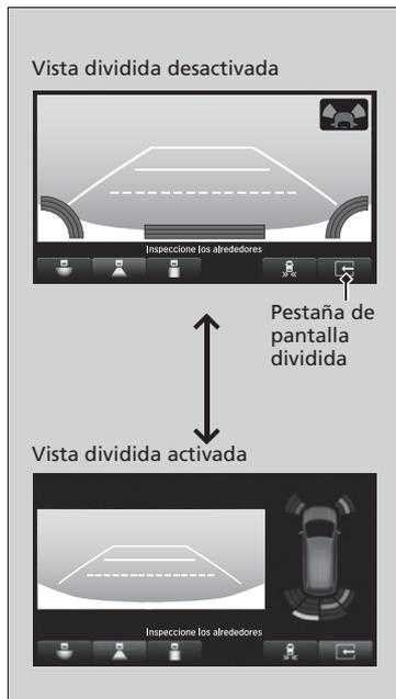
Puede cambiar entre activar y desactivar la vista dividida tocando la pestaña de la pantalla dividida.
