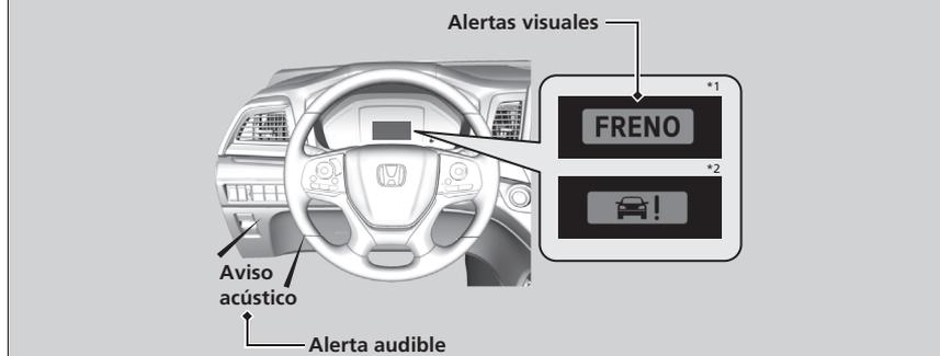
Puede cambiar la distancia (**Alejado/Normal/Cercano**) entre vehículos a la que se activa la alerta de colisión más temprana del sistema a través de las opciones de configuración de la pantalla del sistema de audio/información.
