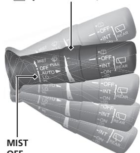
Tire hacia usted para pulverizar líquido lavaparabrisas.
