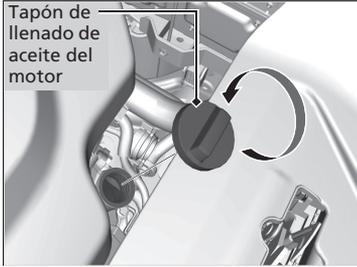
1. Desatornque y retire el tapón de llenado de aceite del motor.
