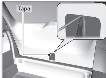
1. Con un destornillador de punta plana retire la tapa de la parte trasera del maletero.
