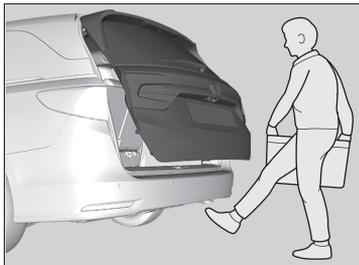
Mueva la pierna hacia delante y atrás, como la acción de dar una patada, durante aproximadamente 1 segundo debajo de la parte central del parachoques trasero para abrir o cerrar la compuerta trasera eléctrica mientras lleva consigo el control a distancia de acceso sin llave.
