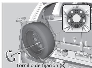
5. Instale el neumático pinchado sobre el soporte con el interior de la rueda mirando hacia usted.
