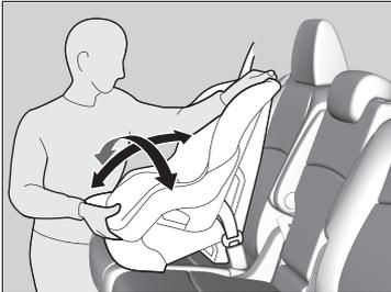
5. Tome la parte del hombro del cinturón de seguridad cerca de la hebilla y tire hacia arriba para eliminar cualquier holgura de la parte de la cadera del cinturón.
